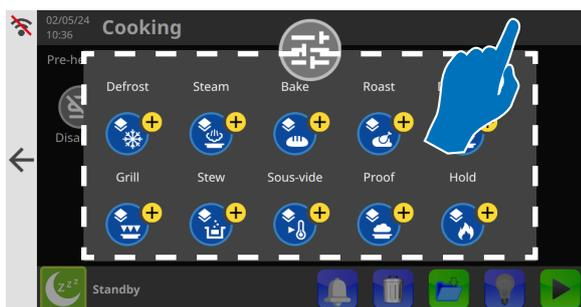
**REMARQUE :** pour fermer la fenêtre des phases prédéfinies sans faire de sélection, il suffit d'appuyer sur l'écran à n'importe quel endroit en dehors de la fenêtre en question.
