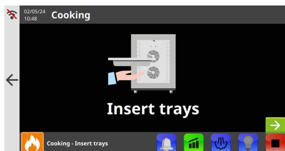
Pour les fours avec chariot uniquement, insérer la cloison thermique pour effectuer le préchauffage. La page-écran rappelle de retirer le chariot et d'insérer la cloison, si nécessaire. On peut ignorer cette opération en appuyant sur la flèche verte. Si le four est laissé sans chariot et sans cloison, l'appareil ne permettra pas de poursuivre les opérations et exigera l'insertion de l'un des deux équipements.
