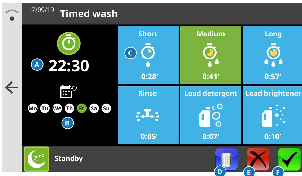
Réglage de l'heure du (des) jour(s) d'exécution du programme de lavage. Pour pouvoir programmer un lavage, il faut que l'heure et la date de l'appareil soient correctes. (voir la section « Paramètres » pour plus d'informations)
