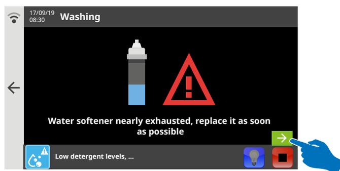
Lorsque l'adoucisseur est presque épuisé, l'appareil de cuisson affiche un signal d'avertissement dans l'icône d'état, pour recommander le remplacement du produit, et la page-écran suivante apparaît au début du lavage. Pour procéder au lavage, enfoncez le bouton vert.
